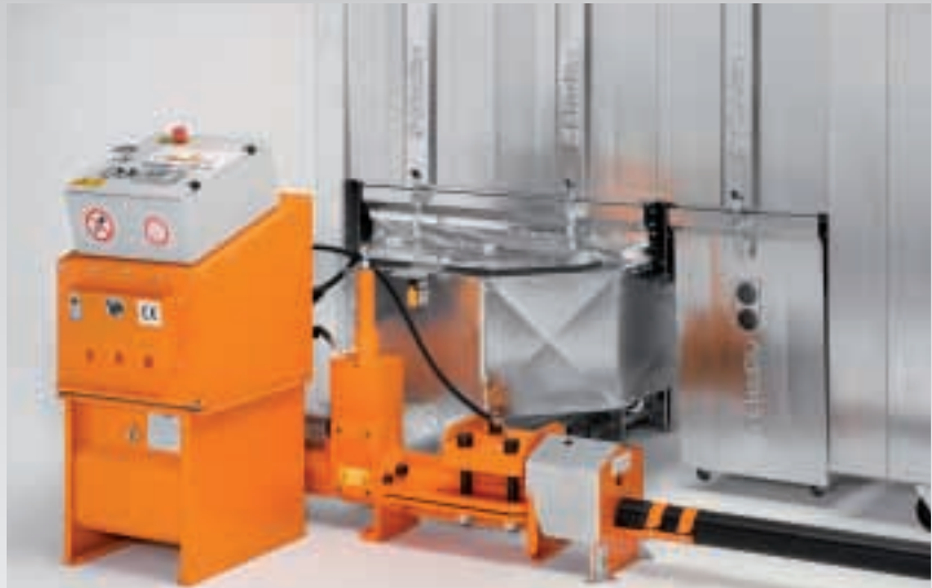
Entstauber VACOMAT 200 XP mit Spänebehälter SPB 50 und einer Brikettierpresse Compacto 700
